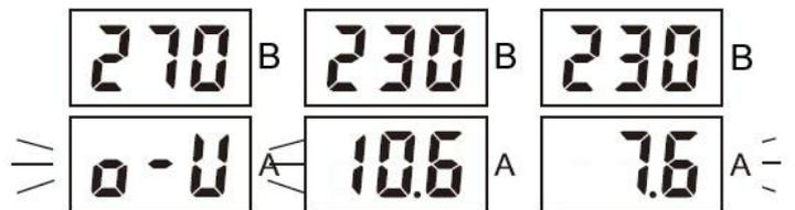
Текущее значение напряжения отображаются на верхних экранах L1-L2-L3, при этом код ошибки по перенапряжению мигает на нижнем экране фазы где произошел сбой.
